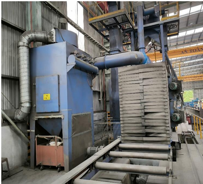
Hình 4.3. Thiết bị lọc bụi đi kèm máy đánh bi
