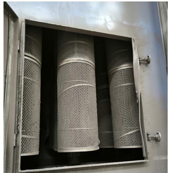
Hình 4.3. Thiết bị lọc bụi đi kèm máy đánh bi
